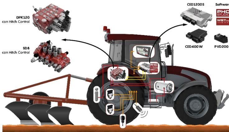
Fig. 4 – Esempio di soluzione per trattore con Hitch Control
